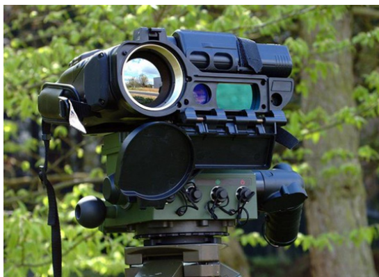
图 13 法国“索菲”SOPHIE-XF/VGA 远距离手持热像仪和目标定位仪 [21]
