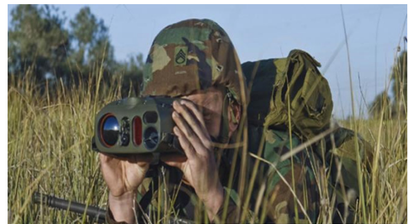
(b) Coral LS 手持远距离热像仪及其使用方式 [20]
