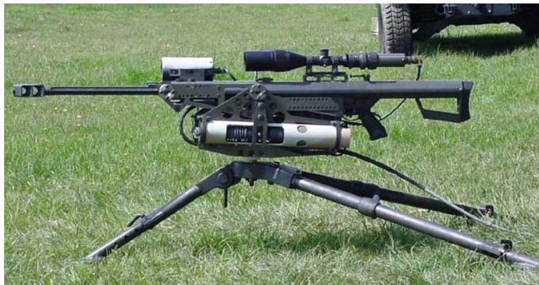
图 20 架设在大口径机枪上的 TRAP-250D 遥控武器站 [29]
