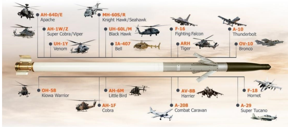
图5 适配 APKWS 系统的 17 种发射平台 [8]
