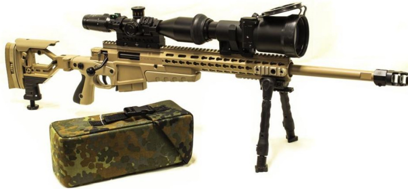
图 18 微光夜视瞄准镜（前）与可见光瞄准镜（后）组合使用 [27]
