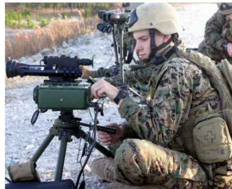
图 15 AN/PAS-21A (SeeSPOT III) 便携式热像仪 [23]
