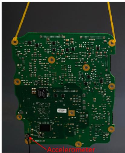
图3 自由模态试验电路板悬挂示意图
