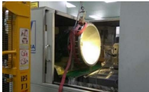
图 9 \phi 682 mm 非球面铝反射镜加工设备
