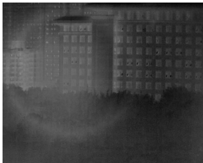
图2 传统方法去除冷反射效果图
