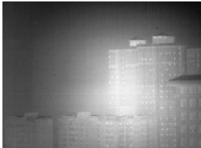
图1 长波红外偏振成像冷反射现象
