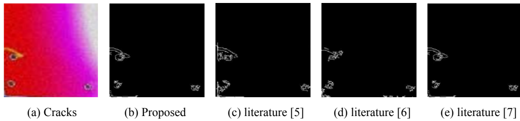
图 18 飞机蒙皮裂痕损伤边缘检测结果
