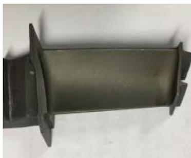
图3 航空发动机工作叶片光学图像
