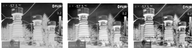
(a) 原图 (b) HE 算法处理图像 (c) CLAHE 算法处理图像 (a) Original image (b) HE algorithm processes image (c) Image processing by CLAHE algorithm
