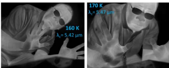
图6 JPL 640 \times 512 规格 InAs/InAsSb 超晶格中波红外焦平面拍摄的照片
