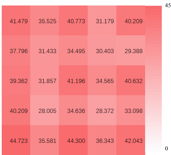
图 16 组合式远红外发射源功率密度分布 ( \lambda=9\mu\text{m} 、 T=90^\circ\text{C} 、 L=3\text{cm} )
