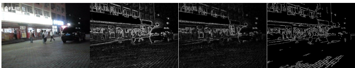
(a) 可见光图像 (b) Sobel 边缘检测图像 (c) Laplace 边缘检测图像 (d) CANNY 边缘检测图像 (a) Visible light image (b) Sobel edge detection image (c) Laplace edge detection image (d) CANNY edge detection image
