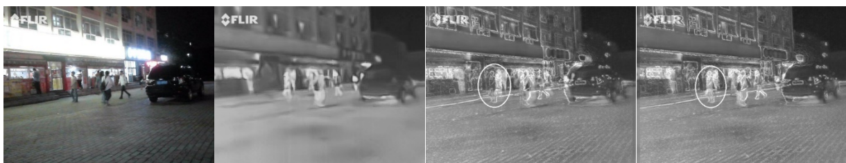
(a) 可见光图像 (b) 热成像图像 (c) 未偏移的融合图像 (d) 偏移操作后的融合图像 (a) Visible light image (b) Thermal image (c) Unshifted fused image (d) Offset fused image
