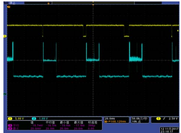
图4 FSYNC和探测器输出图像模拟信号
