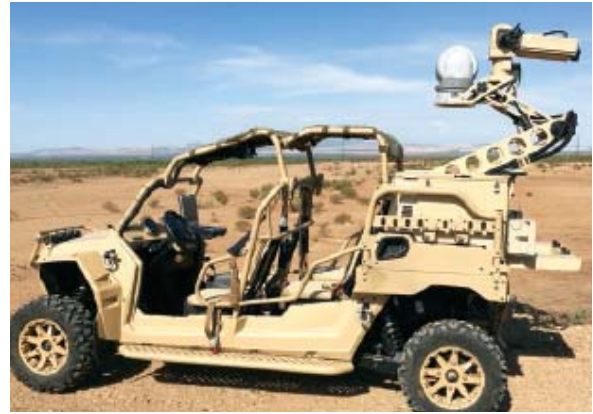
图 7 在越野吉普上安装的 FLIR LTV-X 曲臂式光电桅杆 Fig.7 FLIR LTV-X crank arm electro-optic mast mounted on a jeep
