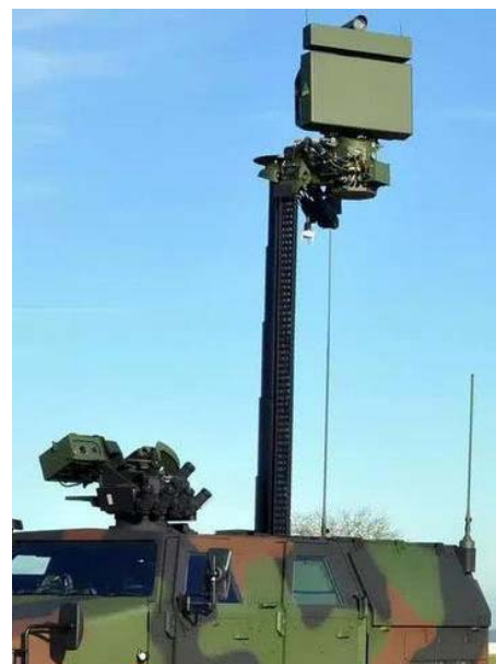
图4 军用车配备的直臂式光电桅杆
