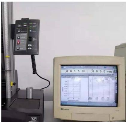
图 13 柔性弹簧刚度测量装置
