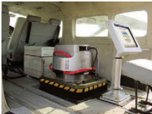
图 10 日本 PASCO 公司 Cessna Caravan 飞机上的 ADS40 Fig.10 Aerial camera ADS40 assembled on Japan PASCO Cessna Caravan airplane
