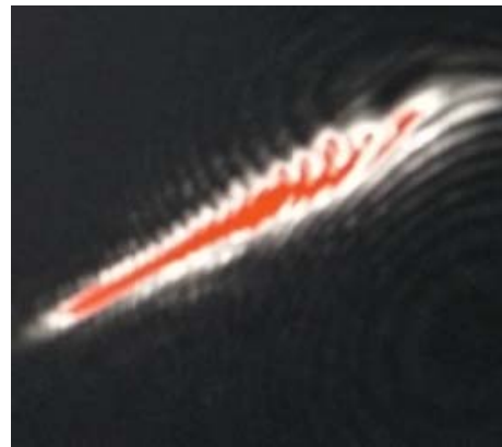
图 11 间距偏差的干涉条纹图
