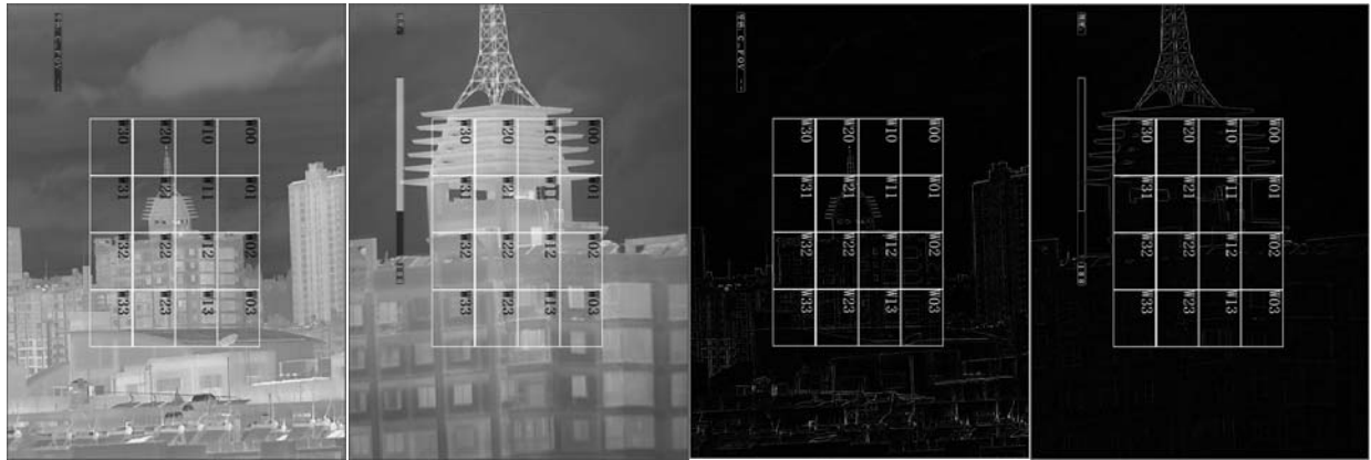
(a) 大视场下的热像图 (b) 小视场下的热像图 (c) 大视场下的拉普拉斯算子滤波后图像 (d) 小视场下的拉普拉斯算子滤波后图像 (a) The thermal image in wide field (b) The thermal image in narrow field (c) The image filtered by Laplace operator in wide field (d)The image filtered by Laplace operator in small field
