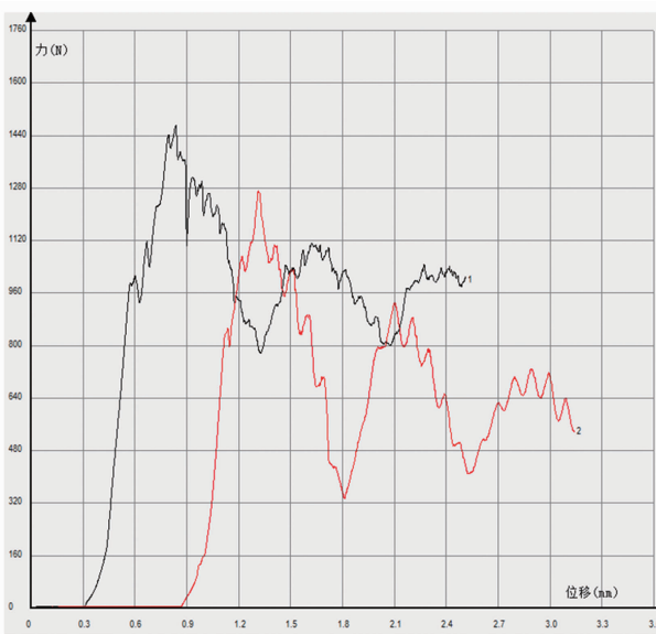
图5 少涂胶磁钢组件的破坏力试验曲线
