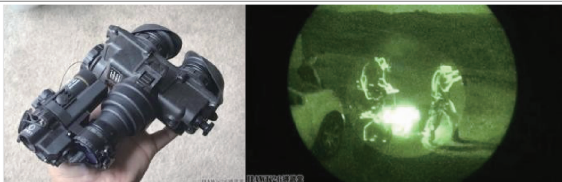
图 5 COTI 安装到 PVS-7 夜视仪上的实物图及效果图 [14]
