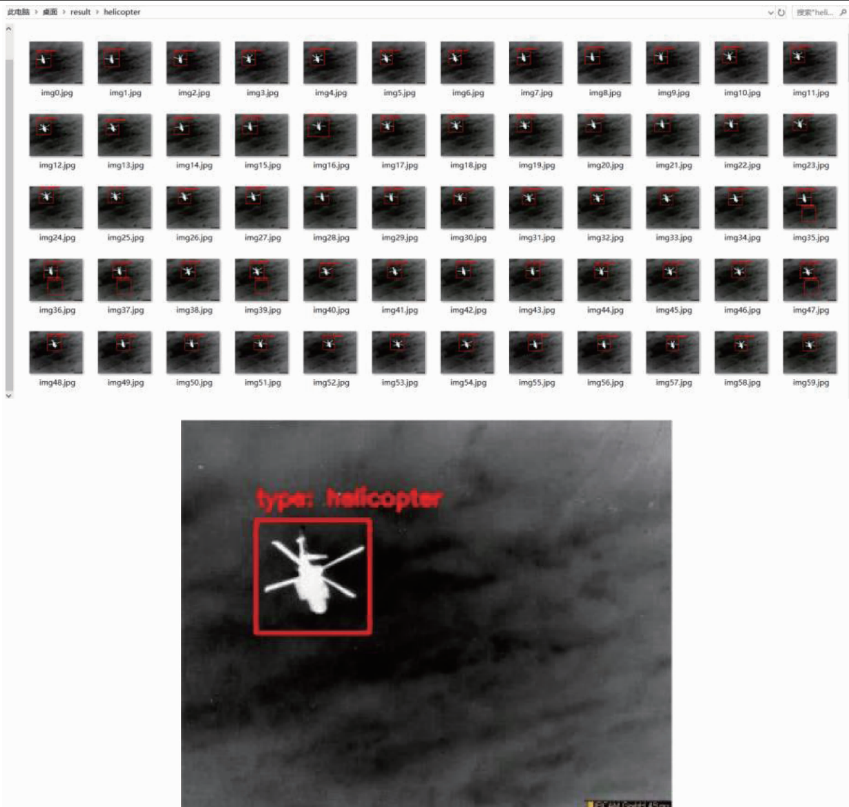
图 9 基于 SVM 算法的红外图像检测与分类
