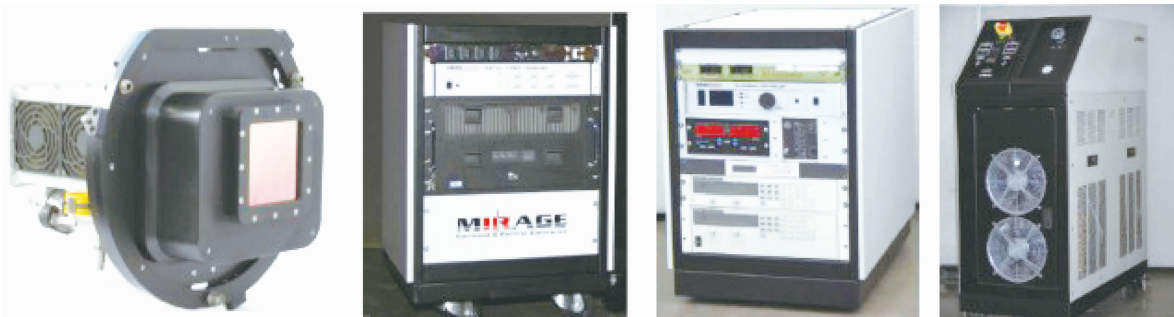
图 15 MIRAGE-XL 电阻阵列主要组成部分的实物图 [11]
