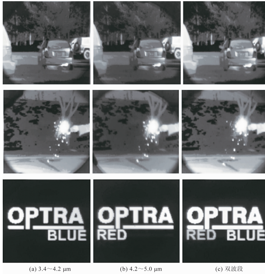
图 13 生成的红外双波段辐射图像 [9]
