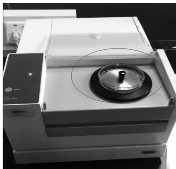
图 2 采集样品光谱时的仪器和附件
