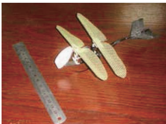
图 10 仿蜻蜓扑翼微飞行器 [23]
