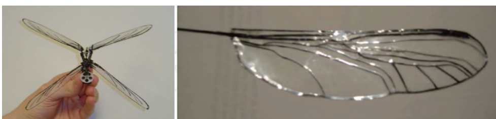
图 14 特拉华大学设计的仿蜻蜓 MAV [25] : (a) 仿蜻蜓 MAV; (b) 仿蜻蜓 MAV 翅
