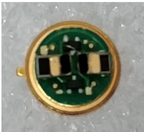
图 5 基于 Mn:PMN-PT 单晶的双通道补偿型(电压模式)热释电探测器的实物图
