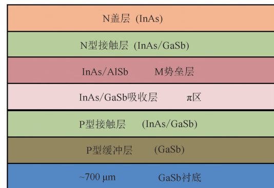
图 1 p- \pi -M-n 双异质结 InAs/GaSb II 类超晶格长波材料的结构示意图
