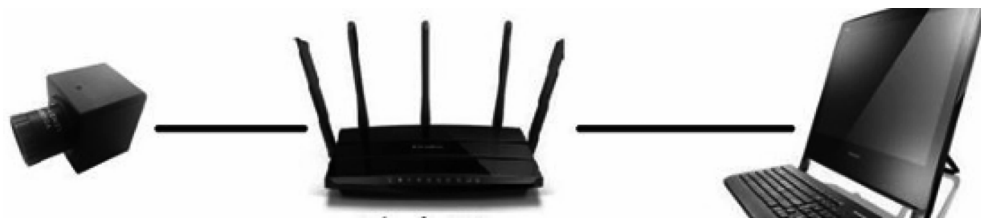
图 1 微风振动在线监测系统的总体架构
