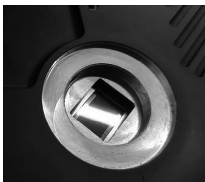
图 9 相机保护玻璃及其端面的反光现象
