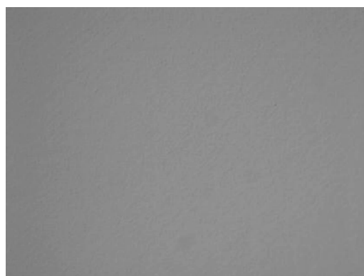
图 7 500 倍下 4 in 硅基碲化镉表面的显微形貌
