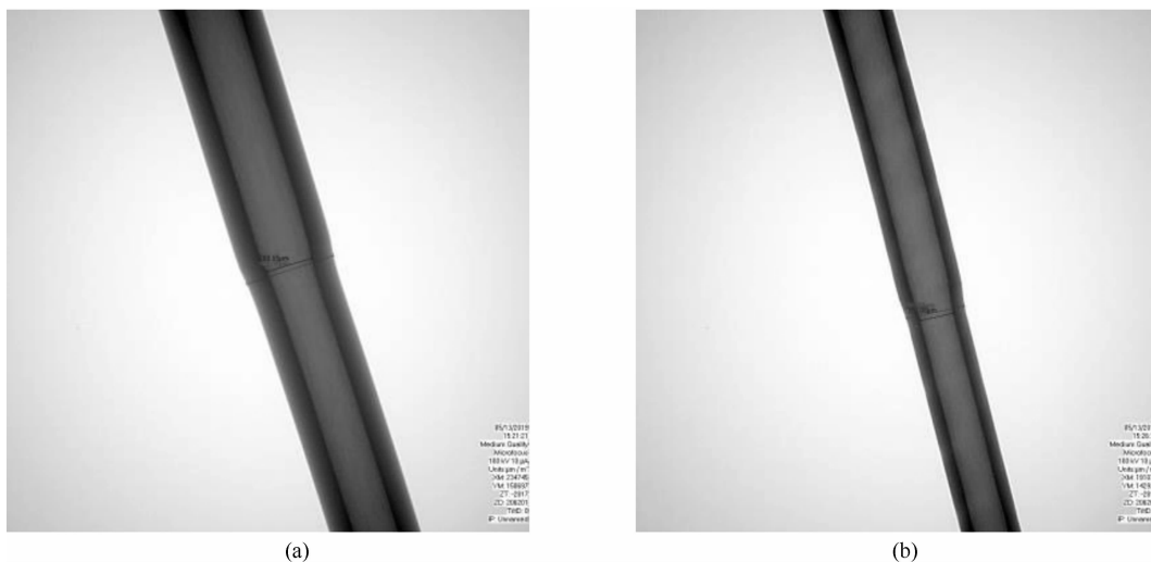
图 9 毛细管尺寸的测量
