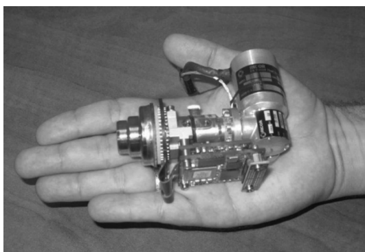
图 16 像元尺寸为 15 \mu\text{m} 的 Mini Pelican-D 型 640 \times 512 元 MBE InSb 红外探测器组件
