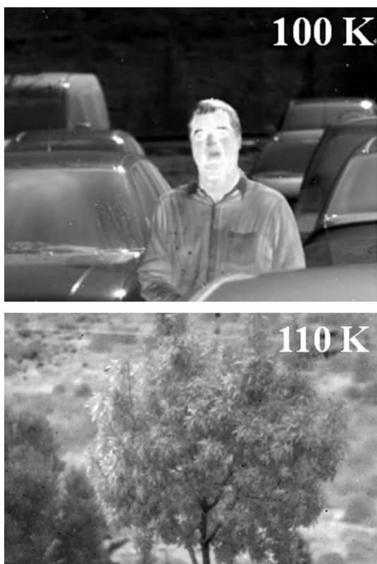
图 19 256×320 元 InAlSb 焦平面探测器在 100 K 和 110 K 工作温度下的成像图像
