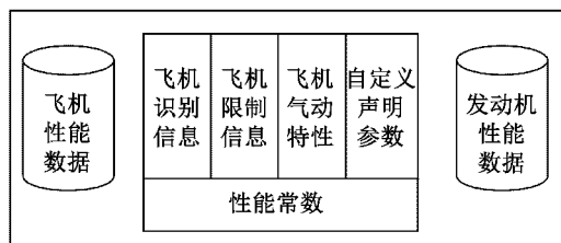
图 2 基于第一法则的机载 FMS 性能数据库内容 Fig. 2 First-principle based onboard FMS performance database content
