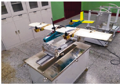
图 5 倾转三旋翼无人机绕 Z 轴转动惯量测量
