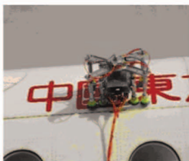
图 1 双框架飞机蒙皮健康检测机器人
