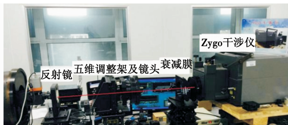
图 2 实验光路结构
