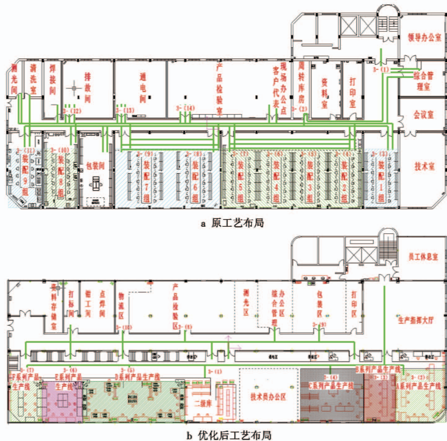
图1 总装车间优化前后工艺布局
