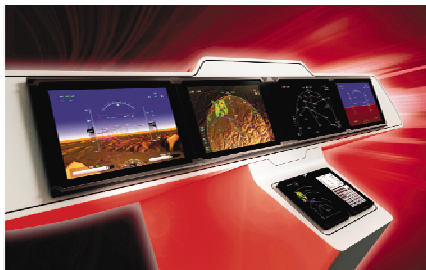
图 1 全触控驾驶舱显示概念
