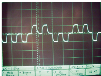
图6 高速时检测到的 ARINC429 数据 Fig. 6 ARINC429 data detected at high speed
