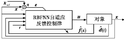
图 2 闭环控制系统结构图
