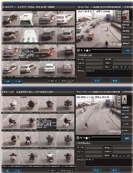
图3 智能视频分析云平台中的人车统计分类功能 Fig. 3 The function of Person/Vehicle classification in cloud platform of intelligent video analysis
