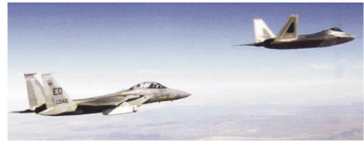
图4 F-15B 外挂 ATIMS IV 吊舱对 F/A-22 进行空中动态红外测量飞行试验
