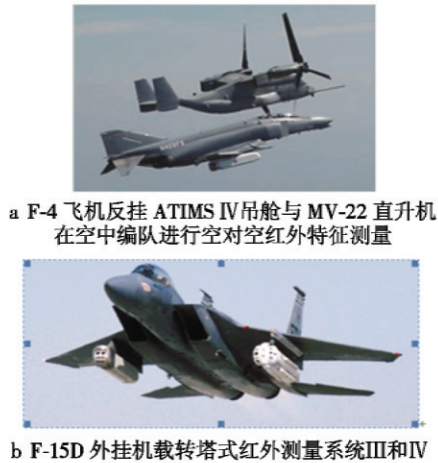
图5 机载转塔式红外测量系统的应用
