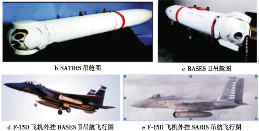
图1 美国空军埃格林基地的机载红外测量吊舱系统
