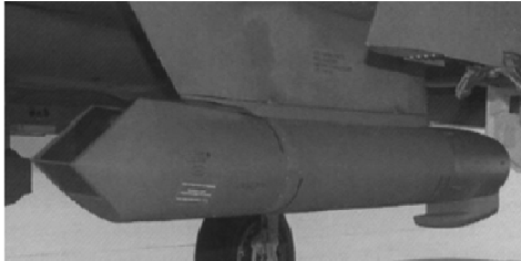
图2 大尺寸圆柱形吊舱(F-15E“攻击鹰”战斗机安装的Sniper XR吊舱)
