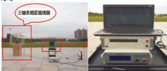
图5 搭建的实验系统(右侧为恒流源和FGM2000)
