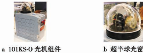
图 7 101KS-O DIRCM 系统 Fig. 7 101KS-O DIRCM system
