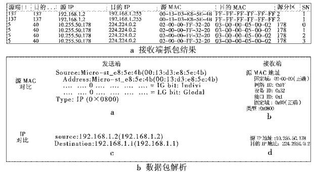
图3 接收端抓包与发送端抓包结果数据帧解析对比
