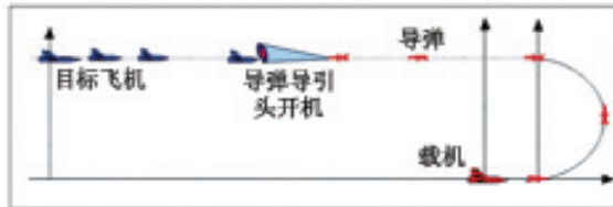
图4 空空导弹侧向/后向攻击过程示意图
