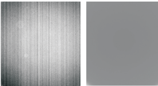
图6 盲元替代前后红外图像对比
