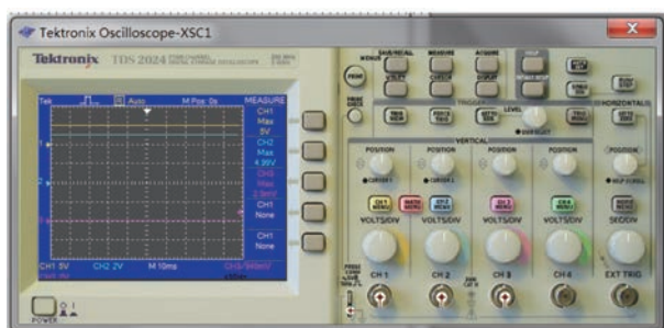
图5 I1 为 500 nA 示波器波形图
