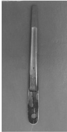
图1 使用353ND胶制作的胶装FBG传感器
