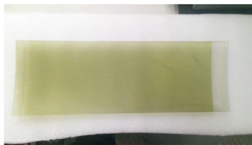
图8 添加消泡剂后聚苯胺墨水印刷涂层图
