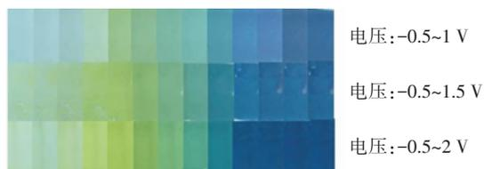
图6 样品4在-0.5~1.0 V电压范围内的颜色变化
