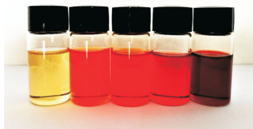
图1 Cd x Zn 1-x Se(x=0~1)系列产物的甲苯溶液照片(从左到右依次为ZnSe、Cd 0.25 Zn 0.75 Se、Cd 0.5 Zn 0.5 Se、Cd 0.75 Zn 0.25 Se、CdSe)
