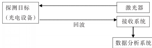
图1 激光回波信号光谱特征探测示意图
